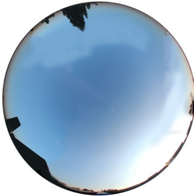
Relevé des masques solaires à partir d'une photographie fisheye
